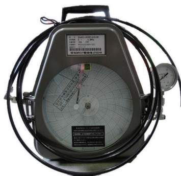
図8 検査機器(気密試験用 自記式圧力計)
