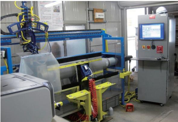
高圧ガス用超音波検査装置
