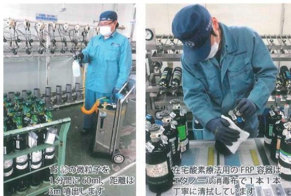
15 分の微粒子を1分間に60ml、距離は3m 噴出します
